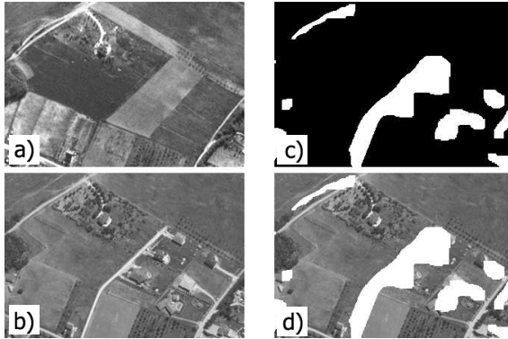
3. ábra. Beépített területek változásának detekciója jelentős időkülönbséggel készült légi képpáron. a)-b) légi felvétel 2000 és 2005 évről c) a detektált változások maszkja (új házak és utak) d) a változasmask visszavetítve a második képre [2.2 tézis]
